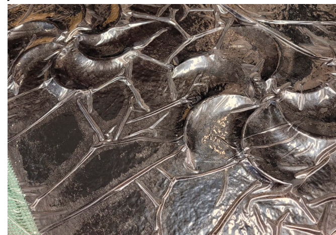
Arkki kostutetaan jälleen hiili-anoputki-nanoselluloosa dispersiolla ja vakuumin/alapaineen avulla elementin pinta kuvioituu.
