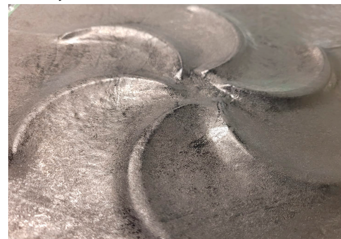
Kun arkki on kuiva käytetty apuaine surfaktantti poistetaan asetoni-kylyvyssä. Asetonin haihtumisen jälkeen elementti on valmis.
