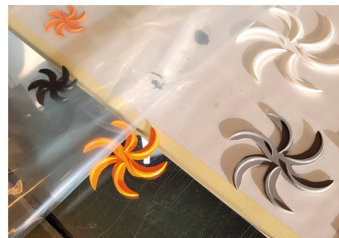
Mustaksi muuttunut ja kuiva arkki siirretään muottiin, jonne on asetettu Pyörre-kuviot 3D kuviointin aikaansaamiseksi.
