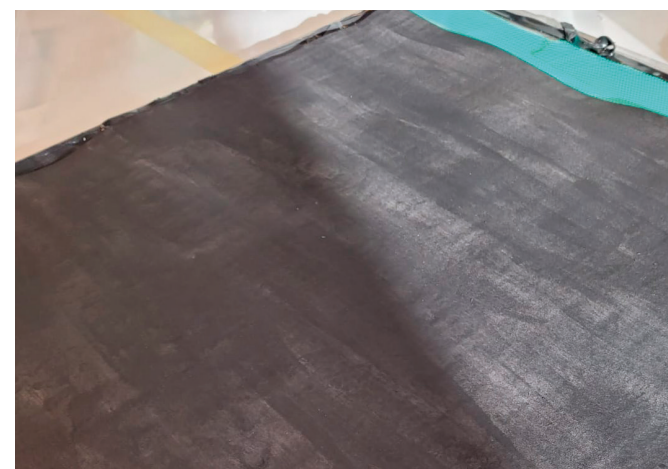
Selluarkin käsittely hiili-anoputkidispersiolla kummaltakin puolelta ja kuivatus.
