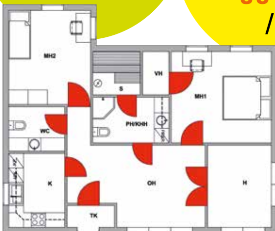
3a KÄÄNTYVÄ OVI VIE KÄYTTÖNELIÖT.
