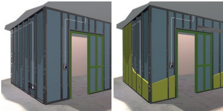
Teräsraangat ja kiskot pysyvät hyvin yhdessä ilman erillistä kiinnitystä, ne kiinnitetään vasta levytyksen yhteydessä. Tämä helpottaa työskentelyä ja lisää myös työturvallisuutta.
