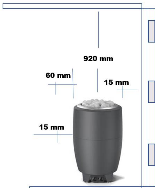
Kuva. Aino –kiukaan minimietäisyydet rakenteista.
